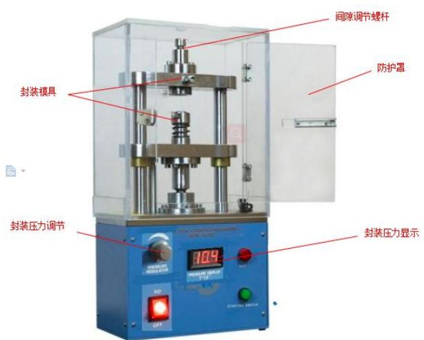
MSK-160E 是一款小型的压力控制性电动纽扣电池封装机，可用于封装 CR2016,CR2025 和 CR2032 扣式电池。此设备采用 24V 直流电池驱动，可在 Ar 环境下的手套箱内使用，用于资助 Li-S, 锂空气和锂离子半电池的测试。数字压力控制器，可保证每次封装时的封装压力一致。这款封装机的尺寸较小，可以通过手套箱的过度仓进出手套箱。
